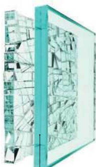
Sticlă securizată Suprafața sticlei în compresie (>10.000 psi)
