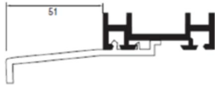
Pièce d'appui en option, monté décalé ou affleure intérieur
